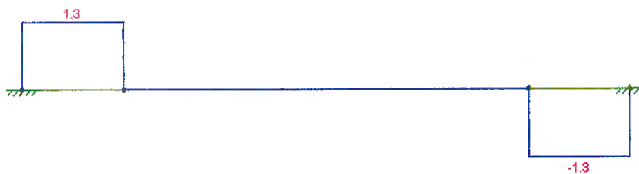
Figura 4-31– Diagrama de Forças Cortantes (kN) – Eixo Traseiro
